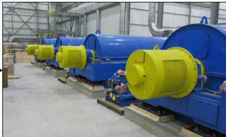
La centrifugeuse dans l'usine de traitement assèche la kimberlite usinée (PK)...
